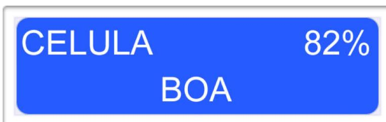
Após a divulgação do resultado do teste, o programa automaticamente retornará ao menu avançado, e estará disponível na 1ª linha do Display o resultado do teste. É importante ressaltar que o resultado só será apagado da tela após as seguintes situações: se a bateria for retirada, se houver o sobreaquecimento dela ou se algum dos três botões de navegação for pressionado.
