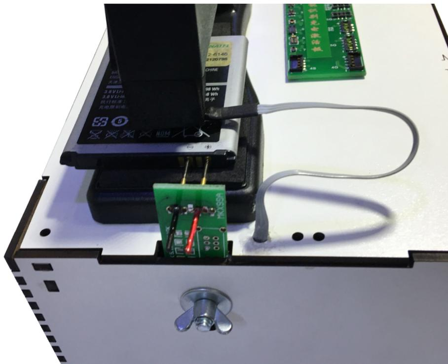
Note que há um ajuste na lateral esquerda do seu Battery Checker 2 para que você movimente os terminais de conexão. É importante ajustá-los para garantir que eles estejam em total contato com os terminais da sua bateria.
