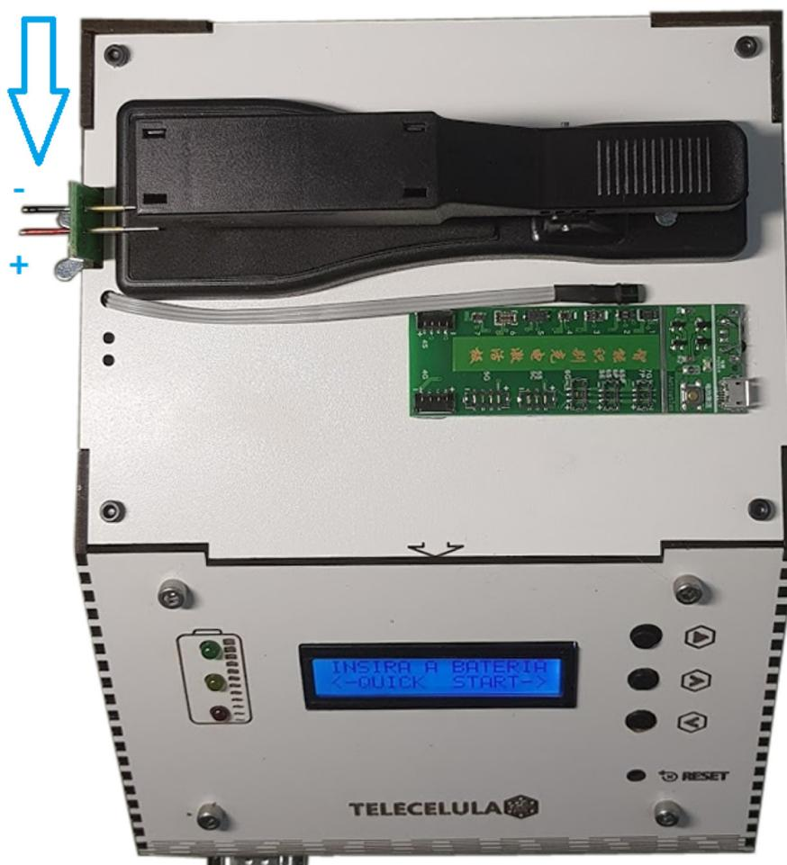
Levante o suporte para garantir que a bateria esteja totalmente presa e imóvel e coloque o sensor de temperatura em contato com a bateria.
