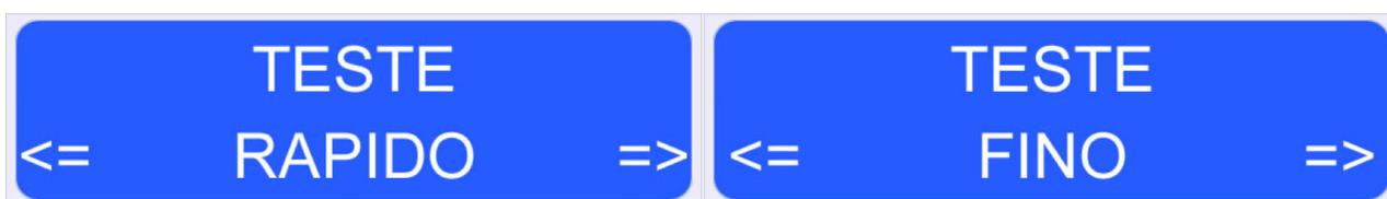
**TESTE RÁPIDO** – É um teste rápido que apenas fornece um parâmetro das condições em que a sua célula de carga se encontra independente da tensão existente nela. É de extrema importância salientar que a bateria poderá estar fora dos padrões adequados (3.7V até 4.0V), uma vez que este teste funciona desde 3.7V até a tensão de 4.4V. Por isso, recomendamos que seja realizado o **Teste Fino**. Não será divulgado a porcentagem do resultado da bateria.
