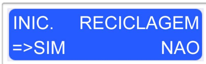
Caso seja feito o **Teste Fino** ou o **Teste Rápido** da bateria e não tenha sido detectado nenhuma corrente, o Battery Checker 2 pode fazer a recomendação de realizar a **Reciclagem** da bateria, aumentando as chances de recuperação desta.
