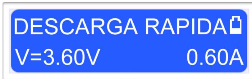
O Battery Checker 2 calcula o tempo estimado da operação. Isso ocorre, pois ele é iniciado quando detectado uma variação de 0.8V da bateria e, assim, o programa tem uma estabilidade para o cálculo do tempo. É importante ressaltar que o tempo estimado é, constantemente, atualizado com as mudanças da propriedade da célula.
