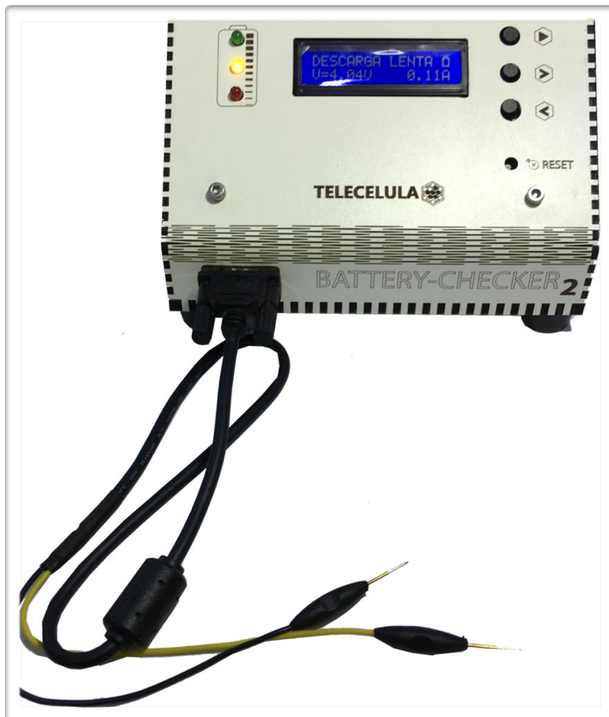
Conecte as pontas de prova nos terminais da bateria: **AMARELA = POSITIVO(+)** e **PRETO = NEGATIVO(-)**.
